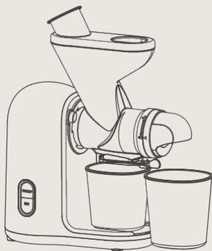
**Coloque los ingredientes de los alimentos en la entrada del cuerpo del exprimidor** y empújelos hacia adentro usando la varilla de empuje.
