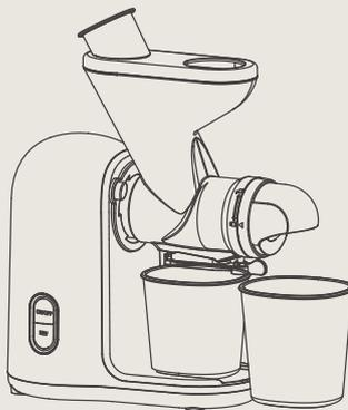
**Coloque el vaso para residuos de fruta debajo de la salida de residuos del cuerpo del exprimidor,** que estará cerca del vaso para jugo (coloque el lado superior del vaso para residuos de fruta cerca de la salida de residuos para facilitar la recolección de residuos).
